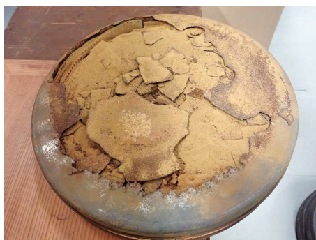
国立映画アーカイブに持ち込まれたフィルム。上: アセテートとナイトレートが混在して固着したフィルム。左下: 袋ごと融解して固まったアセテートフィルム。右下: 缶の錆と硝酸セルロースの化学変化で粉化が進んだナイトレートフィルム
